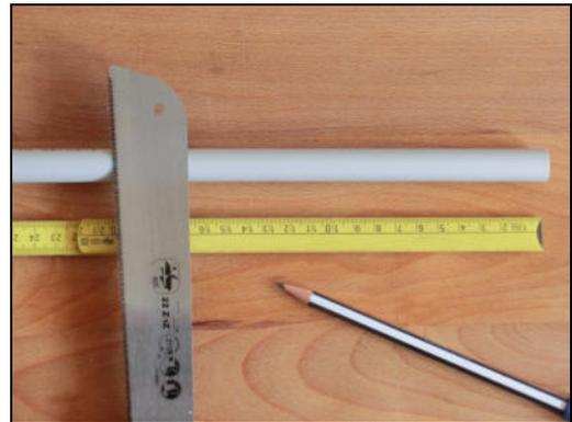
2. die Bohrungen für die Grifflöcher mit der **Bohrschablone** oder dem Lineal markieren, ankönnen und mit **Ø 6mm** bohren.
